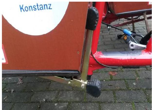
4. Drücken Sie den Fahrradständer anschließend mit dem Fuß nach oben, sodass er **hörbar am Magneten einrastet**.
